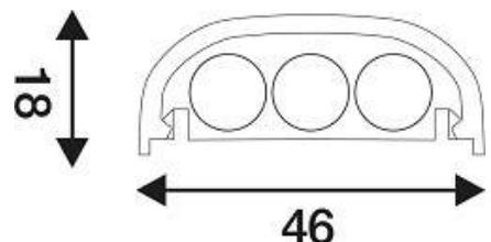
Die NewStar Kabelabdeckung, Modell NS-CC050SILVER, ist eine gute Wahl um Kabel an AV-Installationen zu organisieren. Die Abdeckung versteckt leicht 3 bis 4 Kabel. Das Kabelmanagement verdeckt und führt Kabel von der Flachbildschirmhalterung bis zum Kabelabgang. Verstecken Sie Ihre Kabel, damit die Wand schön und ordentlich bleibt.
